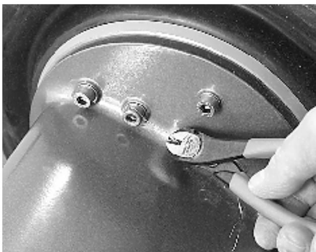
2. Retirer les fils de blocage sur les quatre vis. Déposer ensuite toutes les vis (10) sur la face inférieure du plan de fixation de la transmission.
