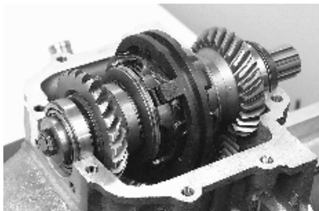
3. Soulever et dégager l'arbre d'entrée, déposer la bague d'étanchéité, les bagues de roulement extérieures et les cales d'épaisseur des deux côtés.
