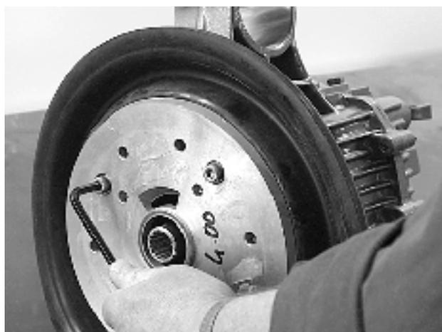
4. Déposer la plaque intermédiaire et retirer le manchon caoutchouc.
