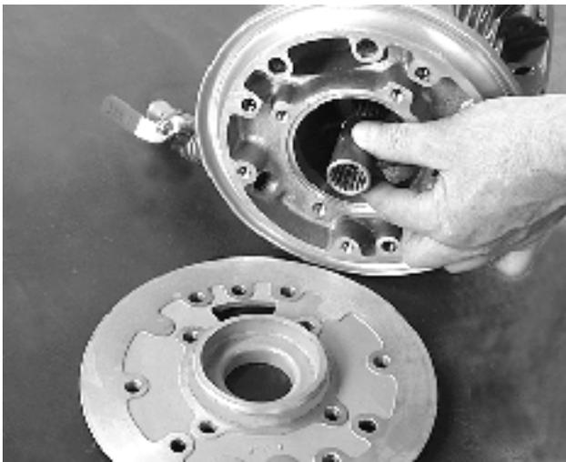
**6. Déposer la douille cannelée.**
