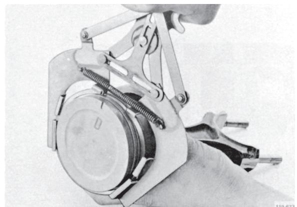
**61.** Sicherungsringe für den Kolbenbolzen ausbauen und Kolbenbolzen herausdrücken.
