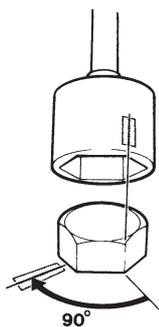
Le serrage à l'aide d'un couple de serrage et d'un angle de rapporteur nécessite d'abord l'application du couple préconisé à l'aide d'une clé dynamométrique, suivi de l'ajout de l'angle nécessaire selon l'échelle du rapporteur. Exemple : un serrage d'angle de 90° signifie que le raccord est serré d'un quart de tour supplémentaire en une opération, après l'application du couple de serrage indiqué.
