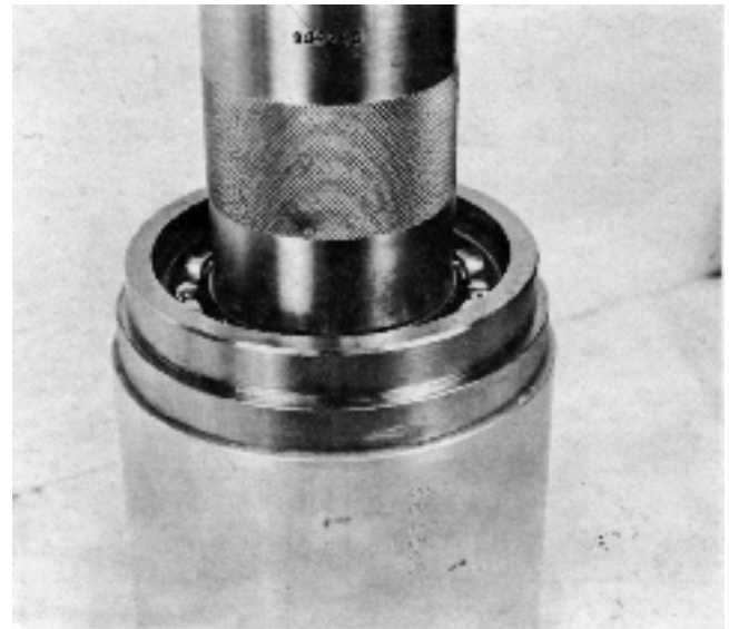
17. Extraire le roulement de la douille de roulement à l'aide des outils 884386 et 884265.
