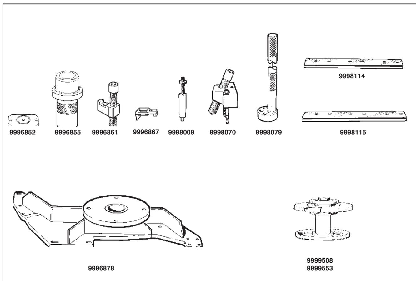
9996852-1 Bride de raccordement pour essai sous pression de culasse
