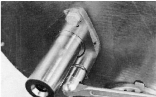
22. Déposer la rondelle butée et soulever l'arbre à cames.
