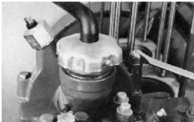
10. Déposer le tuyau de reniflard (ou le dispositif de démarrage manuel).
